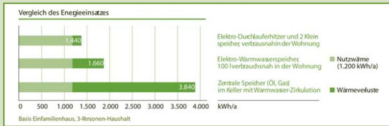
tere Lösung zur Warmwasserbereitung im Vergleich zur zentralen Versorgung über die Heizung. Die elektronisch gesteuerten Geräte sparen nicht nur bis zu 20 Prozent Energie, sie gehen auch schonend mit der Ressource Wasser um. Effiziente Isolierungen bei den Kleinspeichern senken den Bereitschaftsstromverbrauch auf ein Minimum und helfen so sparen.
